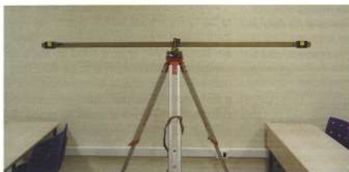
Figura 3 Barra horizontal de invar usada na medição de campo.
